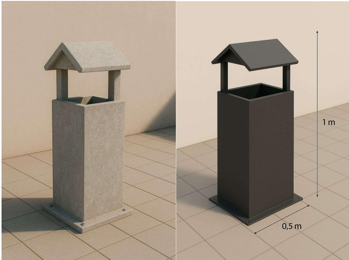
**Descrição:** Lixeiro de forma quadrada, com cobertura triangular sustentada por duas colunas laterais. O espaço entre a parte superior do lixeiro e o triângulo serve como entrada para o descarte de lixo; deverá ser instalado um dreno para evacuação de líquidos nos momentos de limpeza. Material sugerido para que seja feito: alvenaria.
